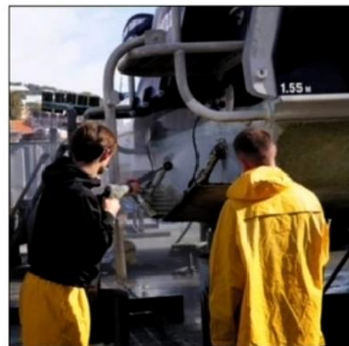
Avant de déposer la peinture antifouling sur la coque de la navette, les élèves doivent s'assurer que rien ne reste collé à cette dernière. Ils utilisent donc de l'eau à haute pression.
